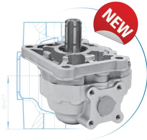
Насосы шестеренные серии «MASTER Plus» производятся для гидросистем с номинальным давлением до 190 бар. Корпусные детали насоса выполнены из специального алюминиевого сплава.
